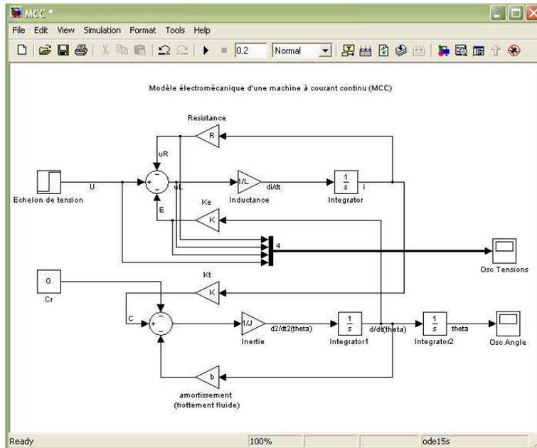
FIGURE 10 – Modèle de la MCC avec oscilloscopes
