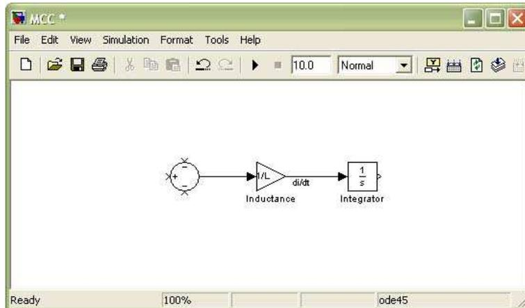
FIGURE 5 – Modèle électrique de la MCC
