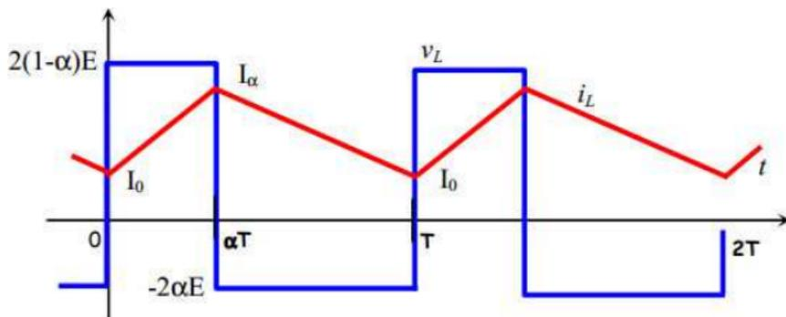
⇒ **La bobine limite l'ondulation de courant**
