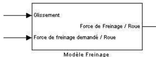
Figure 2: Sous-système modèle freinage
