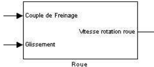
Figure 4: Sous-système roue
